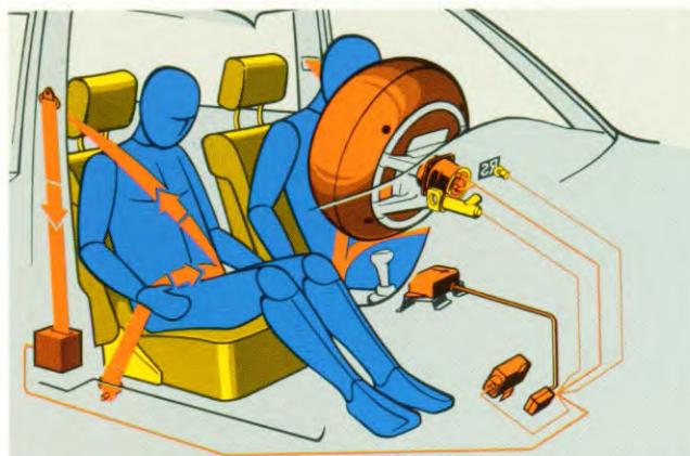
Zo funktioneert het elektronisch gestuurd beveiligingssysteem met luchtzak en gordelspanner (tegen meerprijs).
