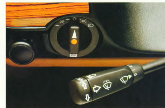
Een goed voorbeeld van het zinvol combineren van verschillende bedieningsorganen is de lichtschakelaar met vier functies en de kombinatieschakelaar met zelfs zes functies.
