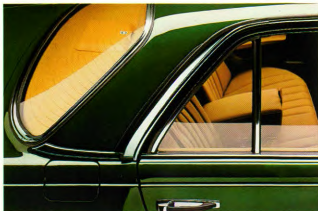
Onzichtbaar weggewerkte sleuven zorgen voor tochtvrije ventilatie.
