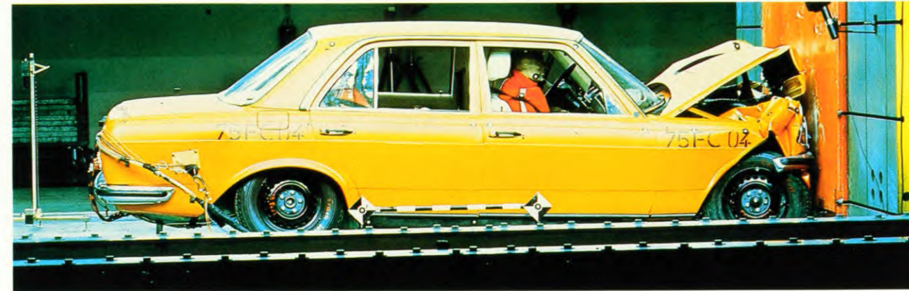
De kreukelzones met progressief oplopende weerstand tegen vervorming bieden bij frontale botsingen en aanrijdingen van achteren de grootst mogelijke passieve veiligheid.
