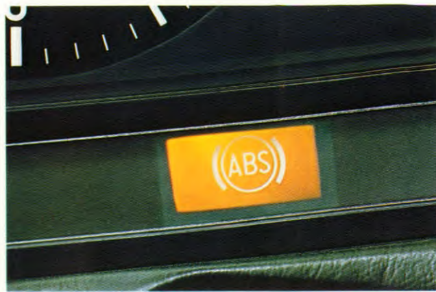
Het als extra leverbare Anti-Blokkeer-Systeem garandeert ook op natte, besneeuwde of beijzelde wegen optimale remwerking en besturing.
