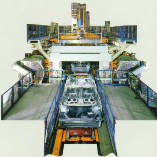
De flexibele produktielijn voor de montage van de personenwagenkarrosserieën. Hier kunnen alle modellenseries in elkaar gelast worden.
