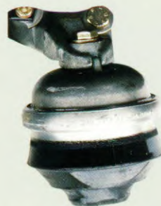
Voor een nog hoger rijcomfort zorgen de hydraulisch gedempte motorsteunen.
