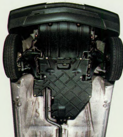
Wij hebben de Diesel ingepakt. De volledige kapseling van de motor maakt onze Diesel bijna net zo stil als een benzine-model.
