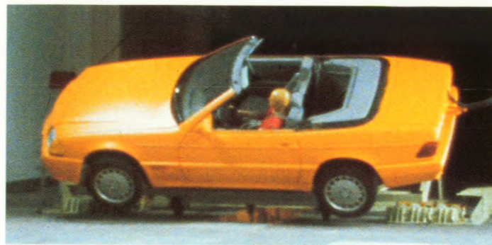
De SL bij de koprol-test. De rolbeugel komt nog niet in beeld. Maar schakelaars aan de rechter veerarm van de achteras kondigen
