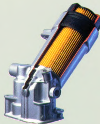
De oliefilter is „staand“ gemonteerd en kan van bovenaf schoon en milieuvriendelijk worden vervangen.
