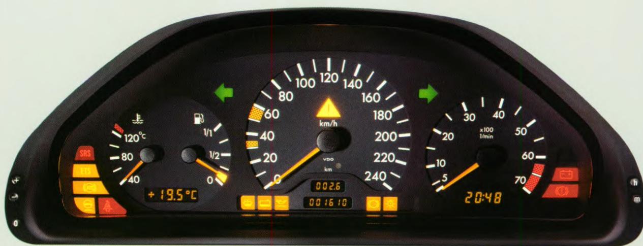
Veiligheid in één oogopslag: het nieuwe instrumentenpaneel met buitentemperatuurmeter en controlelampje voor ETS.
