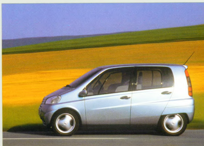
Om ruimte te creëren werden bij de Studie A de motor en de versnellingsbak onder de auto gemonteerd.
