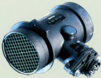
De luchtmassameter zorgt voor een optimaal brandstof-/luchtmengsel.
