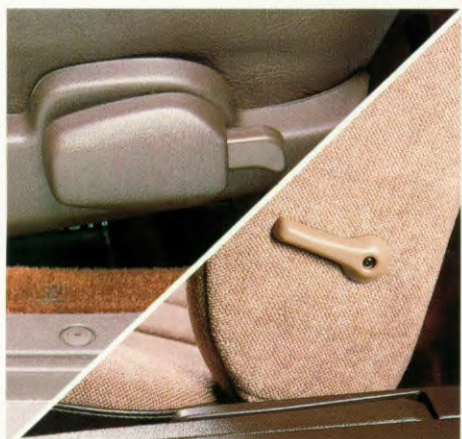
D/E. Hoogteverstelling/lendesteunverstelling bestuurdersstoel
