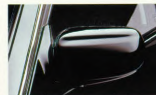
Elektrisch bedienbare zijspiegels met regenspoilers.
