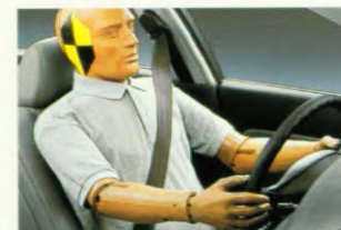
De voorgordels zijn voorzien van een voorspanmechanisme.
