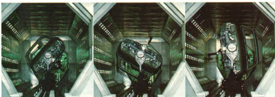
Rotatie-moffelen. Een techniek waarbij de lak zowel gedroogd als gemoffeld wordt terwijl, door het wentelen van de carrosserie, de werking van de zwaartekracht wordt opgeheven.
