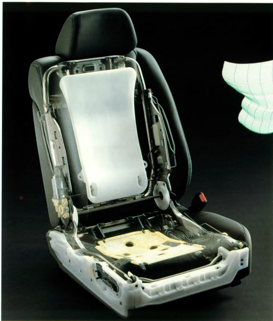
Door de binnenstructuur van de voorstoelen wordt het lichaamsgewicht optimaal verdeeld.
