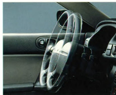
Telescopische stuurkolom voor optimale rijpositie.
