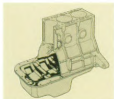
De tussen het motorblok en het oliecarter gemonteerde trilling-onderdrukkende plaat.
