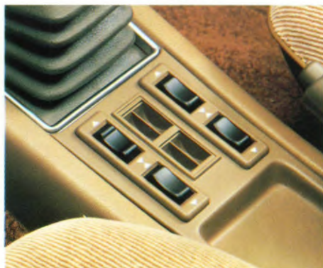
Elektrisch bediende ramen *
