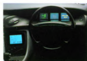
Instrumentenpaneel van het Safe Driving System
