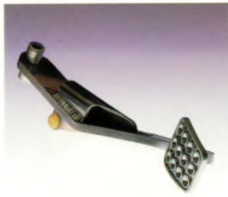
1. Geheel aluminium 'double wishbone' ophanging voor alle vier de wielen. 2. Geventileerde remschijf. 3. Aluminium rempeedaal.
