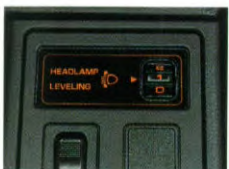
De schakelaar die het koplampniveau regelt bevindt zich nabij de versnellingspook. De bestuurder kan de lampen in drie verschillende hoekposities plaatsen, afhankelijk van de rijomstandigheden. Deze mogelijkheid garandeert verhoogde veiligheid.
