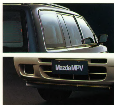
De glad afgewerkte carrosserie zorgt voor een vermindering van het windgeruis. De in de voorbumper geïntegreerde spoiler zorgt voor extra stabiliteit bij hoge snelheden.
