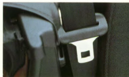
In hoogte verstelbare gordels met gordelspanners.
