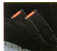
De bevestiging van de veiligheidsriemen in de nieuwe 323 is een voorbeeld van Mazda's zorg voor het vertrouwen en comfort van de bestuurder. Als de stoel wordt verzet, blijft de riem altijd op de juiste spanning, omdat die aan de stoel is bevestigd.
