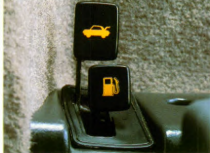
Van binnenuit ontgrendelbaar koffer- en tankdopslot
