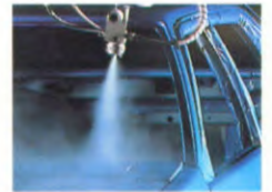
Om de nieuwe 323 een hele speciale 'finishing touch' te geven, introduceerde Mazda één van de meest geavanceerde laktechnieken. Eerst worden de staalplaten gesneden met behulp van laserstralen. Vervolgens wordt met behulp van robots die zijn uitgerust met een verfpistool de lak aangebracht. Het resultaat is een ongeëvenaard gladde en glanzende laklaag.
