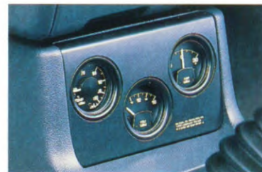
3 4 5 Meterpaneel (zonder meters) B467-W2-415 G (3+4) / B481-W2-415 F (5) Sportiviteit en informatie functioneel bij elkaar gebracht. Niet voor LX modellen. Afgebeelde meters in het paneel: Ampèremeter B470-W2-410 F Olietemperatuurmeter B468-W2-410 F Voltmeter E001-W2-410 F
