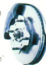
Inwendig geventileerde schijfrem
