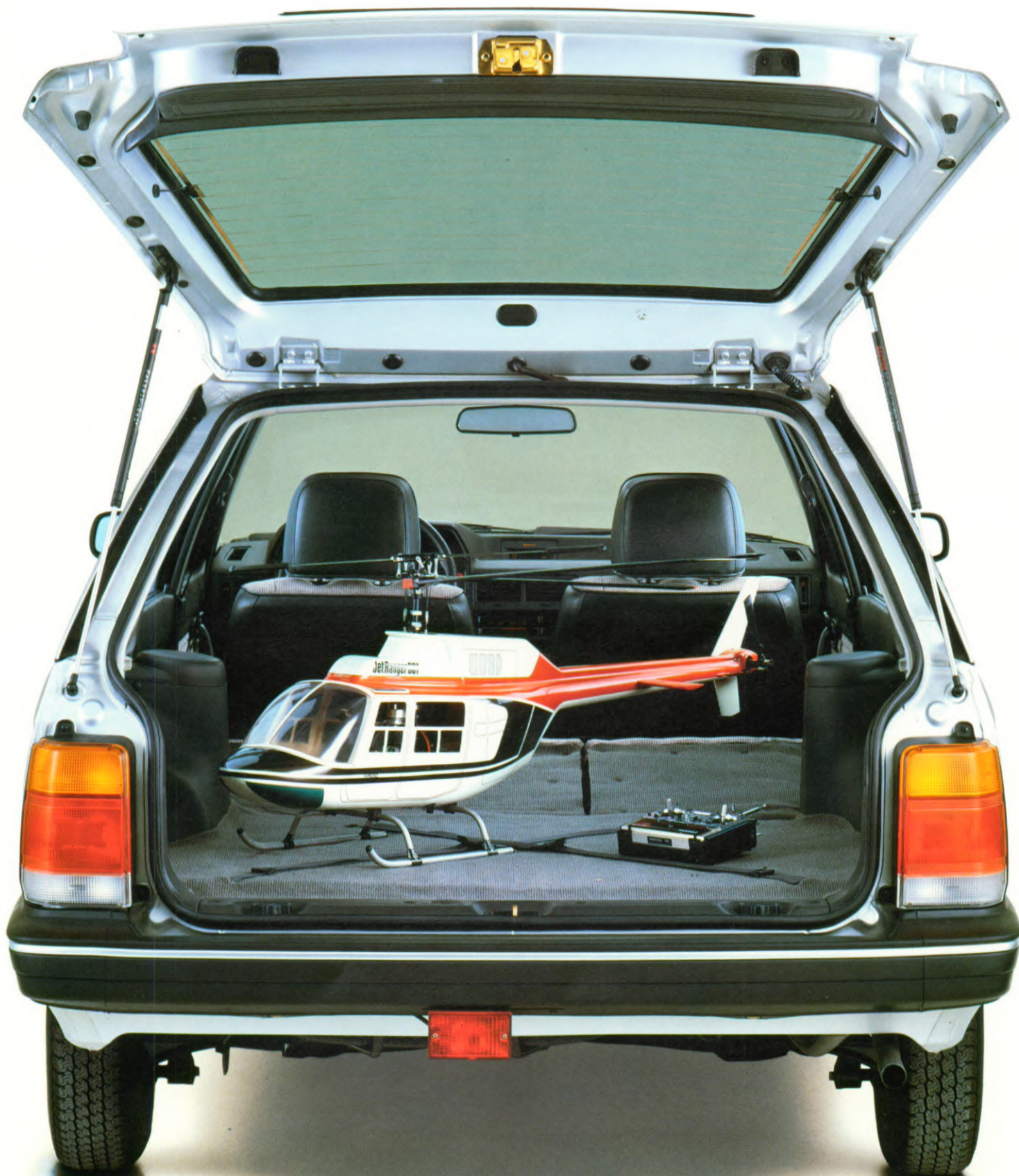
GLX-uitvoering, afmetingen achterklep: 75 x 107 cm; drempelhoogte: 61 cm
