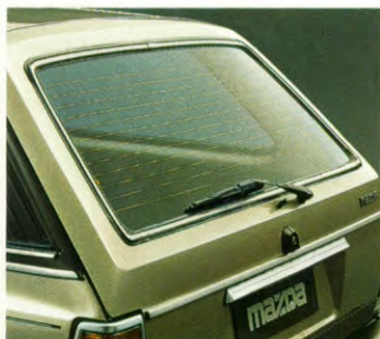
Electrisch verwarmde achterraut met wis- en sproei-installatie
