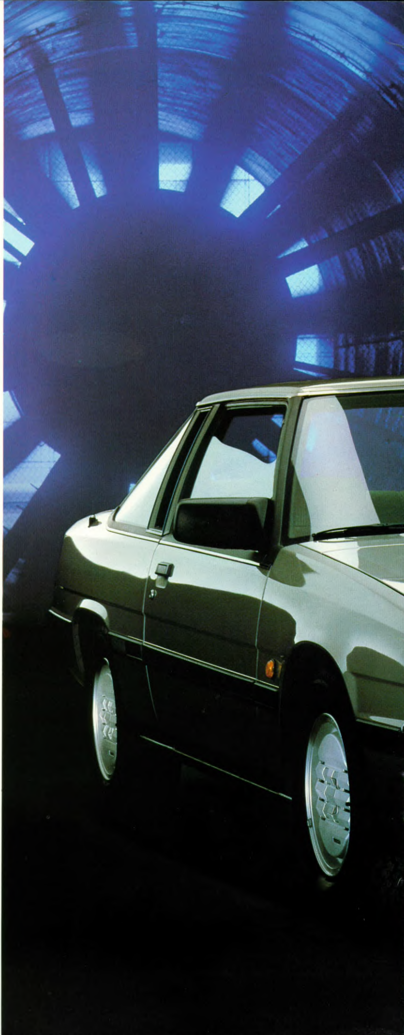
De perfecte aerodynamische styling geeft de Mazda 929 Coupé de laagste CW-waarde in zijn klasse: slechts 0.32
