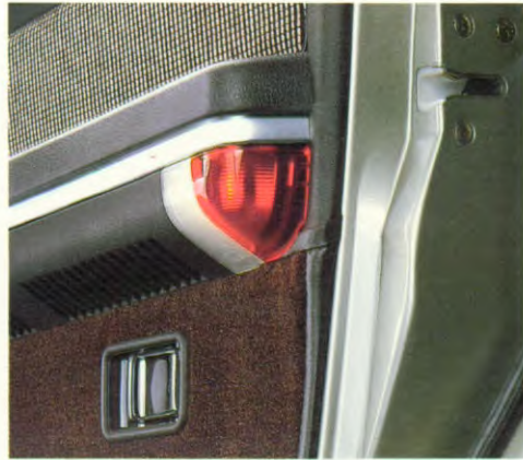
Portiervelichting met vertragsrelais, waarschuwt bij geopend portier ook achteropkomend verkeer
