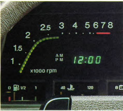
Nauwkeurige L.E.D. (Light Emitting Diode) toerenteller
