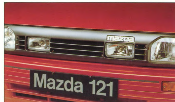
6. Schijnwerper grilleset, wordt geleverd in verstraler- en mistlamp-uitvoering.
