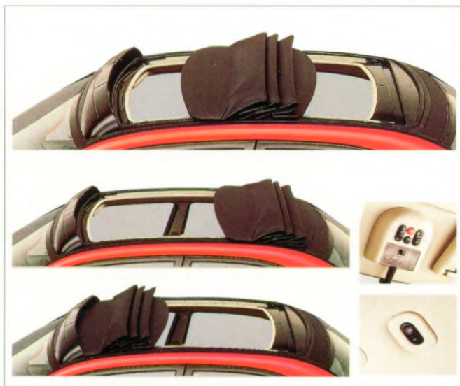
Met een schakelaar voorin en achterin kan het cabriodak van de Cabrio Top elektrisch geopend en gesloten worden.
