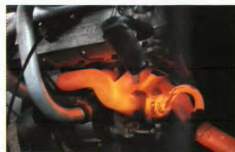
Motor op de testbank tijdens een duurproef met maximale belasting.
