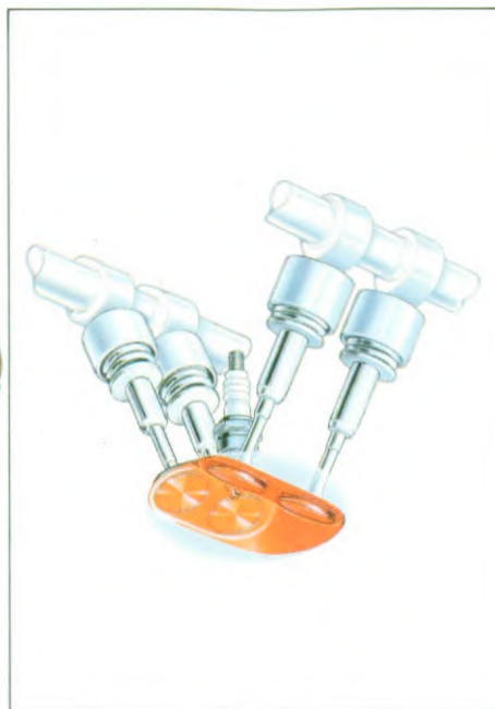
De configuratie met 4 kleppen per cilinder.
