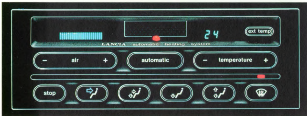
Bedieningspaneel van de automatische verwarming, die een constante temperatuur waarborgt.
