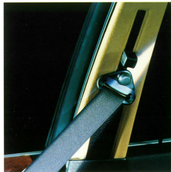
De veiligheidsriemen zijn voorzien van een vijftraps hoogter verstelling.
