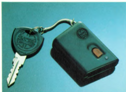
De handige afstandsbediening van de portieren, in een compacte sleutelhanger (op Thema Turbo 16V en V6 standaard).
