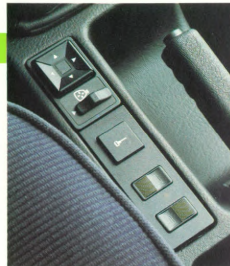
Op de console zijn de bedieningsknoppen geplaatst voor de elektrisch verstelbare en verwarmde buitenspiegels, die kunnen worden ingeklapt, waardoor men bij het parkeren gemakkelijker kan manoeuvreren.
