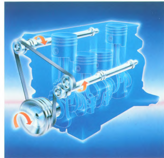
De tegengesteld draaiende balansassen.
