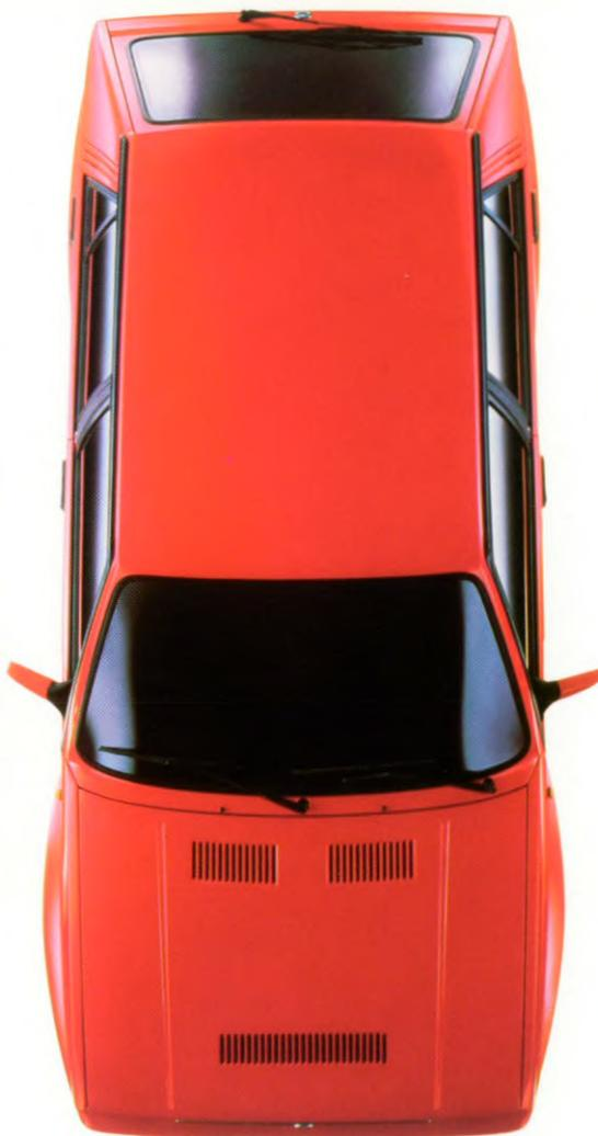
I parafanghi sono stati maggiorati per poter ospitare i pneumatici che sono stati aumentati sia nel diametro che nella larghezza e sono del tipo per altissima velocità, per scaricare meglio la potenza a terra e migliorare la tenuta di strada. Nuova grigliatura di aerazione ricavata nella parte anteriore del cofano motore.
