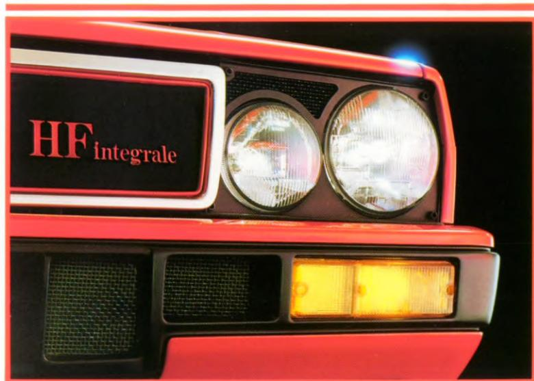
Nella parte frontale del paraurti sono state ricavate delle prese d'aria e nella mascherina sono state inserite delle feritoie per un miglior raffreddamento dell'acqua e dell'olio motore, dell'intercooler e dei freni anteriori.
