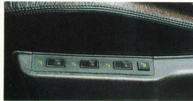
Elektrische stoelbediening om zo comfortabel mogelijk te zitten (optional).
