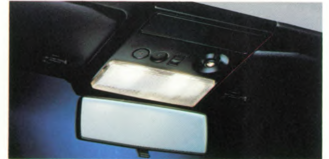
Plafonnière met instapverlichting en kaartleeslamp. Het lamphuis bevat ook de schakelaar voor het elektrisch te bedienen schuifdak (als extra leverbaar).
