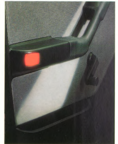
Iedere armsteun is aan de achterzijde voorzien van een reflector om bij geopend portier het achteropkomend verkeer te waarschuwen.
