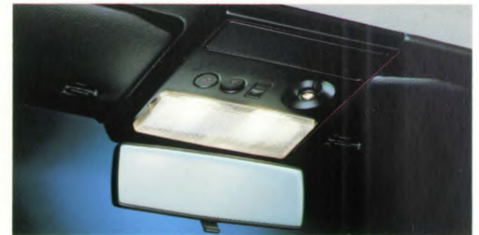
Plafonnière met instapverlichting en kaartleeslamp. Het lamphuis bevat ook de schakelaar voor het elektrisch te bedienen schuifdak (als extra leverbaar).
