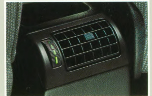
Tussen de voorstoelen bevindt zich een luchtrooster, met verlichte regelknop, voor de directe toevoer van warme of koude lucht naar het achtercompartiment.
