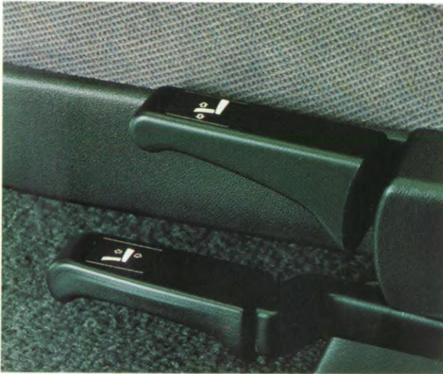
Met de handverstelhefbomen kan de stoelrugleuning traploos versteld worden en is tevens de hoogte van de stoelzitting te regelen.
