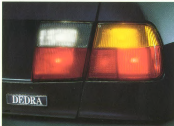
Om esthetische en functionele redenen zijn de effectief werkende achterlichten deels in de spatschermen en deels in het kofferdeksel opgenomen.
