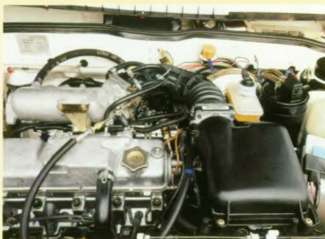
Nieuw: De Lada Samara 1,5 i met Multi-point-Injectie.
