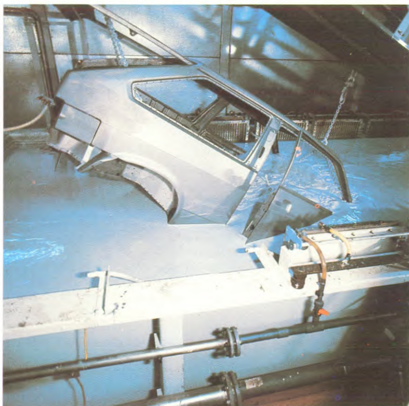
Door gebruik te maken van katalforese, een baanbrekend behandelingsprocédé voor de carrosserie kan de levensduur worden verlengd.
