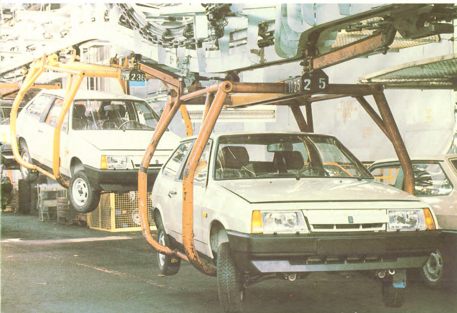
Voor de productie van de Lada Samara werden de fabrieken voorzien van tientallen ultramoderne bewerkingsmachines, montagebanden, gerobotiseerde afdelingen en worden de onderdelen computer-gestuurd aangevoerd.
