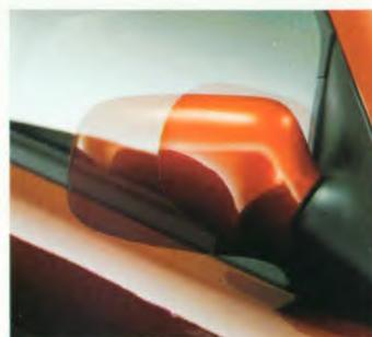
*Einklappbare, getönte Außenspiegel lassen sich beim SLX manuell und beim GTX/GLX elektrisch von innen einstellen. (Beim GTX und GLX in Wagenfarbe lackiert.)*
