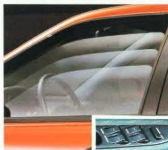
*Der Sephia GTX/GLX ist serienmäßig mit elektrischen Fensterhebern vorne und hinten ausgestattet. Diese werden über ergonomisch gestaltete Schalter betätigt.*
