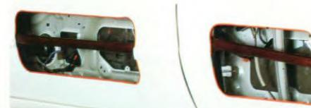
Verbesserter Seitenaufprallschutz durch optimierte Struktur des Rahmens und der Schutzelemente in den Türen.
