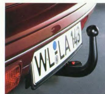
*Zugvorrichtung mit abnehmbaren Kugelkopf als Zubehör erhältlich. Die praktische Abrundung des Transportprogramms. Die Zugvorrichtungen verfügen über eine Anhängelast von 555 kg (ungebremst) bzw. 1.200 kg (gebremst).*
