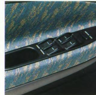
Die zentrale Steuereinheit für die elektronischen Fensterheber ist in der Fahrertür integriert. Abb. Sephia GTX Fließheck.
