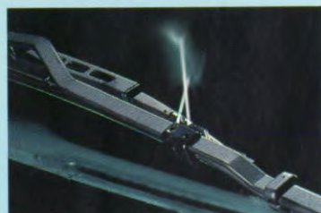
Düsen der Waschanlage in die Wischerblätter integriert
