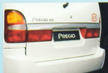
Heckblende mit integrierten Nebelschlußleuchten (Abb. enthält Sonderausstattung)
