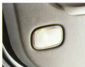
INSTALAMPJES IN DE VOORDEUREN
