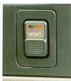
Schakelaar hoogte- regeling
