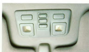
Schakelaar elektrisch schuifdak
