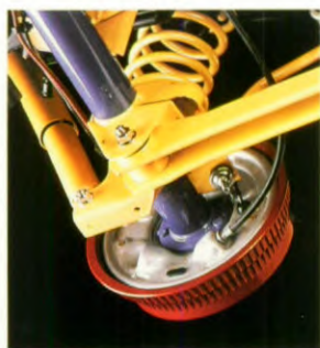
De unieke Quadra-Coil wielophanging van de Grand Cherokee bestaat onder meer uit schroefveren met lange veerweg, dubbele wieldraagarmen en heavy duty, gasgevulde schokdempers.
