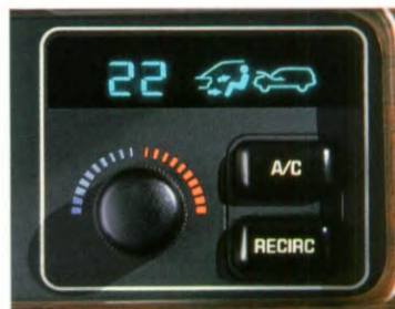
Met de automatische temperatuurregeling van de 5.2i V8 Limited wordt een ingestelde temperatuur zonder verder omkijken gehandhaafd.
