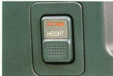
Schakelaar hoogte regeling
