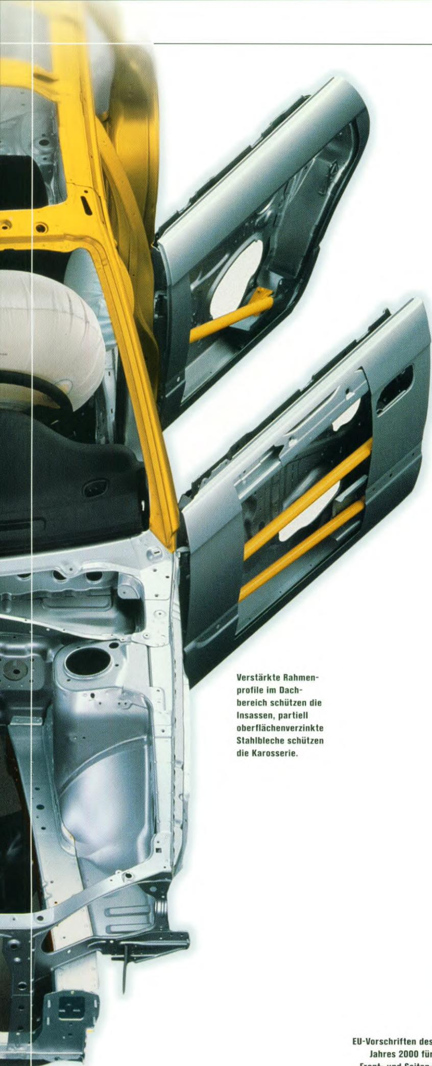
Verstärkte Rahmenprofile im Dachbereich schützen die Insassen, partiell oberflächenverzinkte Stahlbleche schützen die Karosserie.
