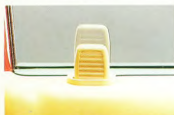
Centrale deurvergrendeling AU4 (Optie)
