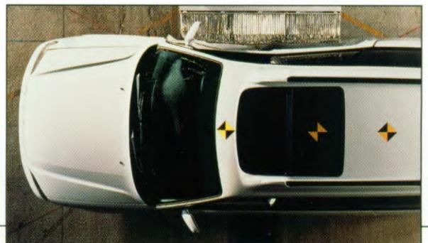
Die Sicherheitskarosserie ist durch verstärkte Rahmenprofile im Dachbereich sowie einen verstärkten Rundum-Aufprallschutz gekennzeichnet. Serienmäßig verfügt der Legacy zudem über zwei Full-Size-Airbags, Gurtstraffer und Gurtkraftbegrenzer, zwei Seitenairbags in den Vordersitzen (GX optional), und auch der mittlere Fondsitz ist mit Kopfstütze und automatischem Dreipunkt-Gurt vollwertig ausgerüstet.
