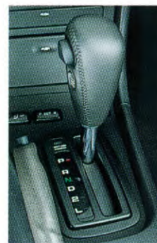
De elektronisch geregelde automatische viertraps transmissie met een lock-up systeem laat zich soepel bedienen en werkt brandstofbesparend. De trappen kunnen worden geblokkeerd, bijvoorbeeld bij bergafwaarts rijden. Een kickdown zorgt desgewenst voor de nodige acceleratie voor bijvoorbeeld een inhaalmanoeuvre.
