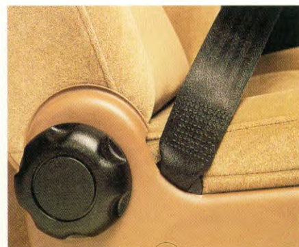
De onderste verankeringspunten zijn op de stoel bevestigd en bewegen mee als de stoel voor- of achterwaarts wordt versteld.
