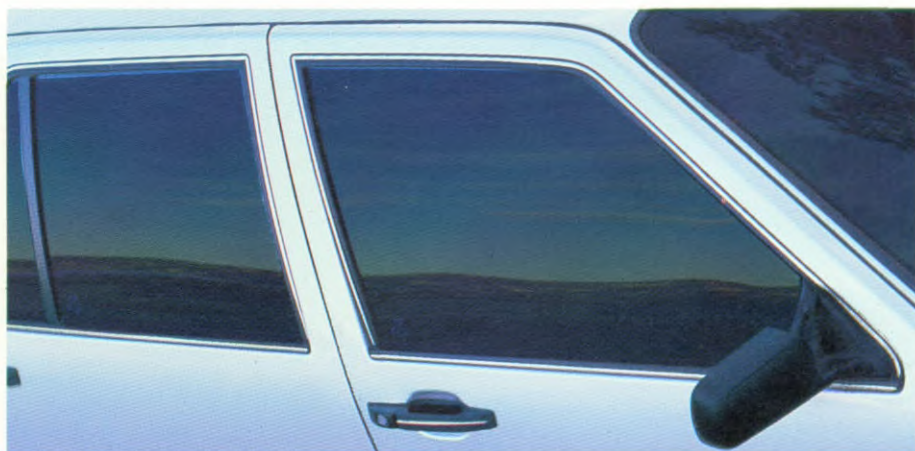
De Saab 9000 heeft vlak in de carrosserie liggende ramen en geen overbodige verfraaiingen die de aerodynamische eigenschappen nadelig beïnvloeden.
