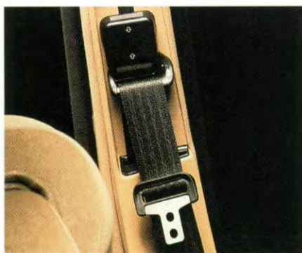
Verstelbare bovenste verankeringspunten voor de veiligheidsriemen voorin.
