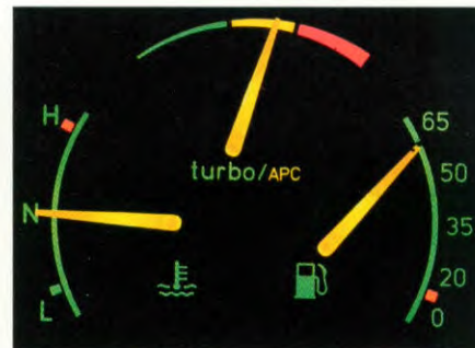
De laaddrukmeter, die zich op het instrumentenpaneel bevindt, houdt de bestuurder voortdurend op de hoogte van de laaddruk.
