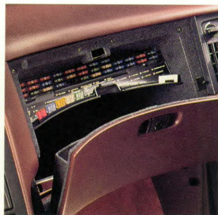
Alle zekeringen zijn gemakkelijk toegankelijk in de beschermde plaats achter het handschoenvakje.
