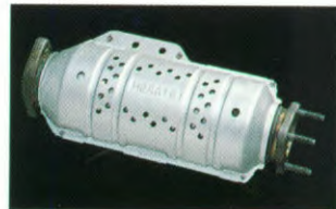
De uitlaatgassen worden door een chemische reactie in een katalysator voor 90% ontdaan van ongewenste bestanddelen.
