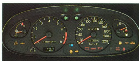
Rode wijzernaalden, grote meterschalen met wit-op-zwart cijfers en een nieuwe verlichtingstechniek maken het instrumentarium uitzonderlijk plezierig en makkelijk af te lezen.
