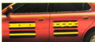
De dwarsbalken in de portieren, ter bescherming bij zijwaartse aanrijdingen, zijn van een extra sterk soort staal.
