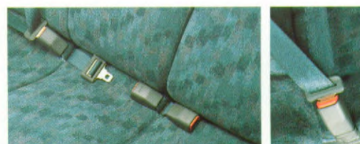
De driepunts gordels voorin kunnen in hoogte worden versteld. Achterin heeft de Lantra twee driepuntsgordels en in het midden een heupgordel.
