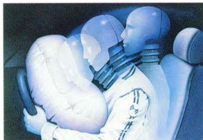
Een airbag in het stuurwiel voorkomt borstletsel bij onverhoopte aanrijdingen (standaard op 1.6 GLS-X en 1.8GT-X).
