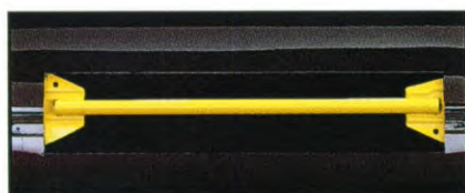
Veiligheidsbalken in de vier portieren bieden bescherming bij aanrijdingen van opzij.
