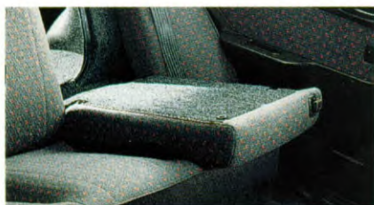
De achterbank laat zich met een simpele druk op een knop 40/60 gedeeld wegklappen. De Lantra is er multifunctioneel mee en kan lange artikelen binnenboord meenemen.
