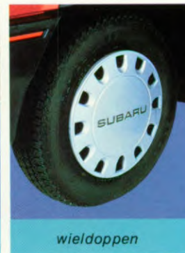
staalgordel radiaalbanden 145 SR 12
