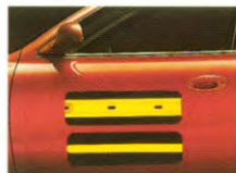
De dwarsbalken in de portieren, ter bescherming bij zijwaartse aanrijdingen, zijn van een extra sterk soort staal.
