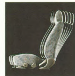
De stoelen bieden ongekend comfort en zijn volledig verstelbaar. De bestuurdersstoel heeft ook hoogteverstelling en een lendesteun (GLS uitvoering). Een verhoging langs de voorkant voorkomt het onder de gordels door schieten bij een botsing.
