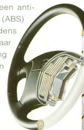
De airbag aan de bestuurderskant is met een inhoud van 60 liter full-size en voorkomt letsel aan borst en gezicht. Hij komt in werking binnen milliseconden nadat de sensor een botsing meet.
