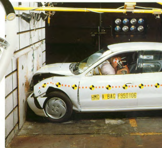
De airbag aan de bestuurderskant is met een inhoud van 60 liter full-size en voorkomt letsel aan borst en gezicht. Hij komt in werking binnen milliseconden nadat de sensor een botsing meet.
