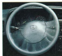
Combinatie van stuurbekerichting en hoogtevastelling van stuurkolom (standaard op 1.5i LS automaat en 1.5i GT en 1.5i GTX)
