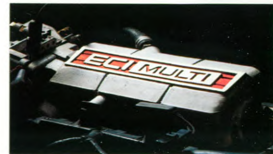
Een moderne anderhalve liter viercilinder motor met multipoint brandstofinjectie vormt het sportieve hart van iedere Hyundai Pony en Excel.
