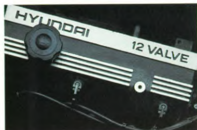
De pittige Alpha-viercilinder, een eigen ontwikkeling van Hyundai, heeft een inhoud van anderhalve liter en drie kleppen per cilinder, bediend door een bovenliggende nokkenas. Voor wie graag de slijtvastheid van het plaveisel beproeft, is hij er in een opwindende versie met turbocompressor.
