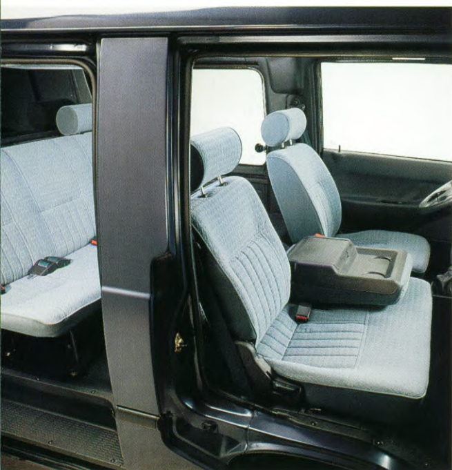
De rugleuning van de bijrijdersbank van de H 100 met dubbele cabine kan in twee delen worden neergeklapt.
