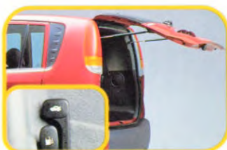
Twee gasgevulde veren helpen bij het openen van de achterklep, bij de GLS is deze van binnenuit te ontgrendelen.
