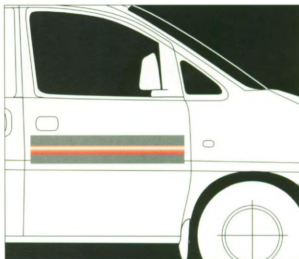
Stalen dwarsbalken in de portieren beschermen de inzittenden bij een aanrijding in de flank.
