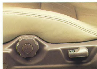
Electrische verstelling van de bestuurdersstoel en draaiknop voor hoogteverstelling.
