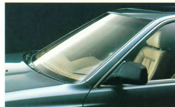
Volledig verzonken ruitwissers en aërodynamisch gevormde buitenspiegels.
